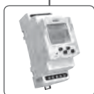
TER-9 2 темпер. входа, 2 выхода 8А переключ., 6 функций, встроенный коммут. таймер, LCD с подсветкой, гальванич. чesки изолированное питание AC 230V, 2 - МОДУЛЬ. Температурный диапазон: -40 °C.. +110 °C.
