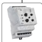
TER-4 Широкий и точный диапазон настроек -40.. +110 °C в 10-ти интервалах в одном устройстве, точная донастройка температуры, 2 входы для NTC сенсора, 2 выхода 16А переключ., дополнит. функции (память, гистерезис, индикация неисправного сенсора). Питание: AC 230 V или AC/DC 24 V (гальванич. изолированное).
