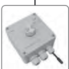
TEV-3 Термостат для регулирования отопления (охлаждения), настраив. диапазон 5..+35 °C, внешний сенсор NTC, выходной контакт 16А, управл. потенциометр и индик. контролька на панели.
