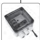
TEV-2 Термостат для регулирования отопления (охлаждения), настраив. диапазон -20..+20 °C, внешний сенсор NTC, выходной контакт 16А переключ.
