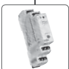
TER-7 Контроль перегрева обмотки электродвигателя в температур. интервале, даном сопротивлением встроенного PTC термистора (1.8-3.3 кОм), дополн. функции (память, сброс). Выходной контакт 2x8А переключ., питание: AC/ DC 24-240 V.
